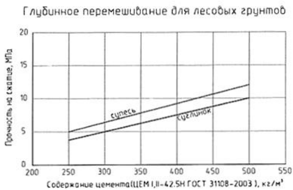
Рисунок Ф.3 - Зависимость прочности грунтоцемента от содержания цемента в 1 м 3 ГЦЭ
